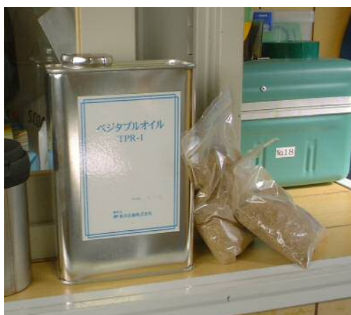
写真 10．ブレーカーの潤滑油として 植物油を使用
