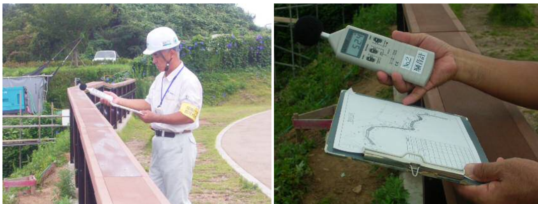
写真 8．現場周辺域の騒音モニタリング状況
