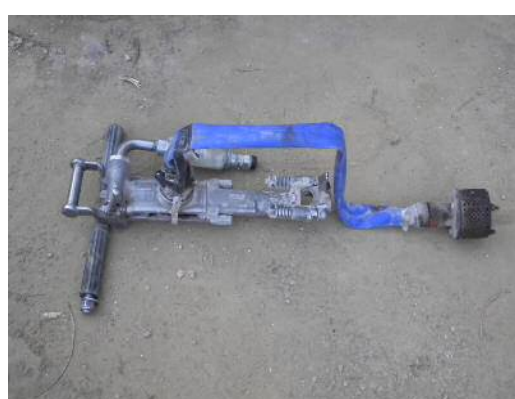
写真 8. 騒音対策のため、消音器を取付けたさく岩機。
